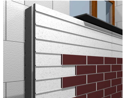
Die Platte IZOALFA ermöglicht eine einfache Wärmedämmung des Gebäudes und seine ästhetische Endausführung.
