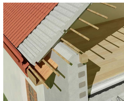
Verbindungsschema der Dachplatte von Izodom mit der Wand.
